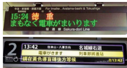
旅客案内表示装置 (上:LED式、下:カラー液晶式)
