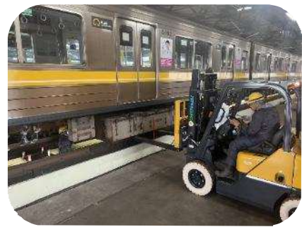
主要電気機器更新
