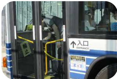
乗降扉の手動操作
