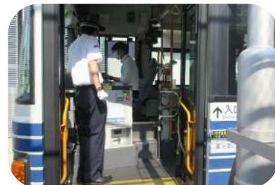
運転席での扉開閉操作
